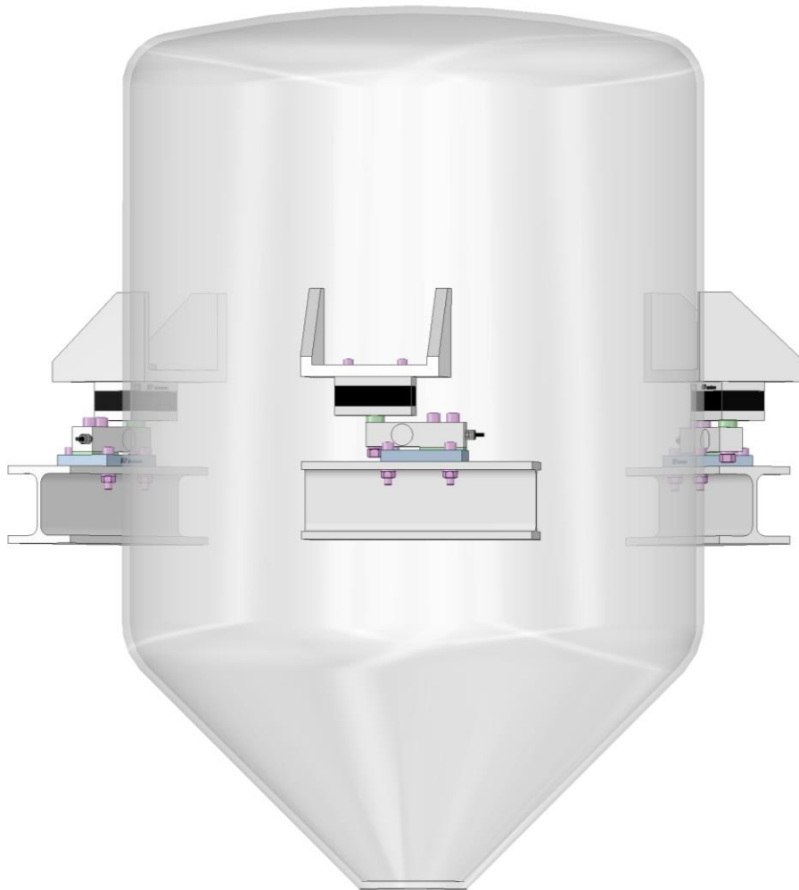
Silo a 3 punti di appoggio.
